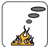
Low Smoke Emission IEC 61034-1&2 EN 50268-1&2/NF C32-073
